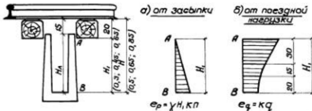
Объемный вес балласта с частями пути  $\gamma = 2 \text{ т/м}^3$
