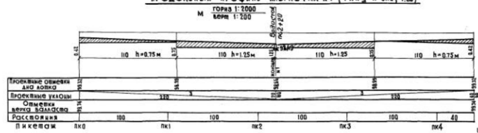
ВОДОУВЛАДИТЕЛЬСКОЕ УСТРОЙСТВО НА СТАНЦИИ ВОДООТВОД ОТ ВЫСОКИХ ПАССАЖИРСКИХ ПЛАТФОРМ НА ПУТКОВОЙ СТРОИТЕЛЬСТВЕ. Генплан, поперечный и продольный профили по варианту I (при щебеночном балласте)
