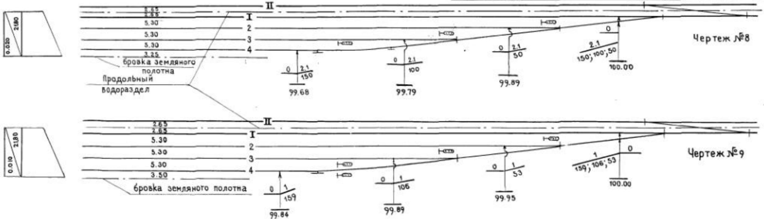
Погашение разности отметок путей при проектировании их в разных уровнях.
