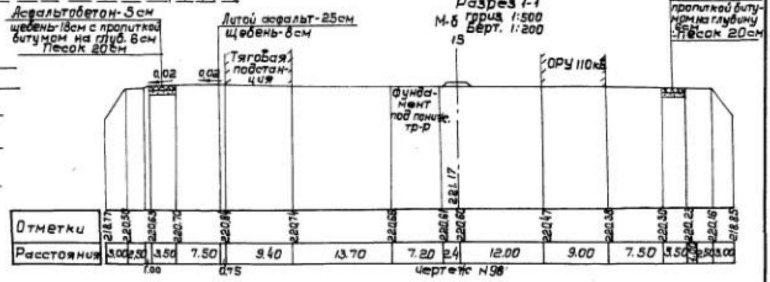
Водотвод от промежуточной тяговой подстанции. Генплан и поперечный профиль
