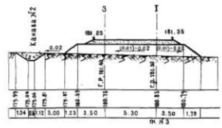
Планы и поперечные профили промежуточной станции и разезда с продольным расположением приемо-отправочных путей.
