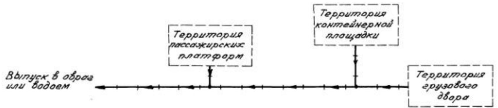
Схема подземной сети водостоков от отдельных площадок с загрязненной поверхностью, с очисткой сточных вод
